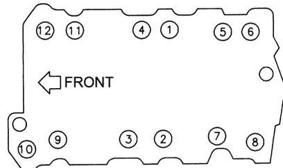
MANIFOLD TIGHTENING SEQUENCE
