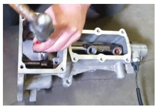
11. Rotate lug then remove roll pin.
