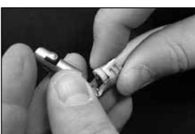
6. Doble levemente las lengüetas del terminal con el alicate. NO LAS APRIETE DEMASIADO. Este paso tiene como finalidad asegurar el cable y el terminal juntos y prepararlos para el engarce final.
