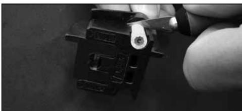
5. Pliegue el núcleo sobre el cable. Introduzca el cable dentro del terminal y coloque la aislación de silicona del cable 3,1 mm (1/8 pulg.) después de las lengüetas de enganche del terminal.
