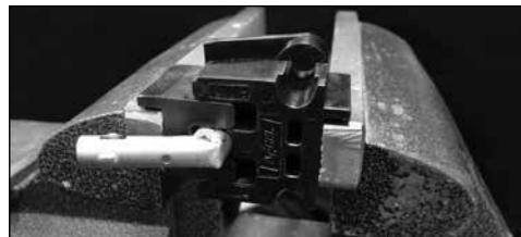
9. Una vez que el terminal esté cerrado alrededor del cable, deje de ejercer presión. NO LO APRIETE DEMASIADO. Si lo hace, puede apretar demasiado el terminal y romper el forro de silicona del cable.
