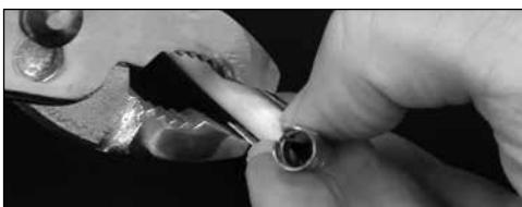
7. Coloque el extremo abierto del terminal enfrentando la "W" en la tenaza engarzadora.
