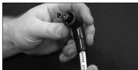
12. Para los capuchones estilo HEI: lubrique levemente el terminal con grasa dieléctrica y haga deslizar el cable dentro del capuchón estilo HEI.
