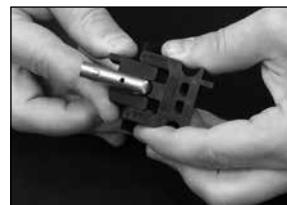
8. Arme la tenaza engarzadora y coloque las lengüetas de alineación dentro de las mordazas de la prensa. Cierre lentamente la prensa, prestando atención a la alineación del terminal.
